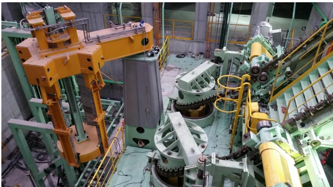
Duas bobinadeiras por deposição e o mastro de transferência para os produtos bar in coil da Primetals Technologies
