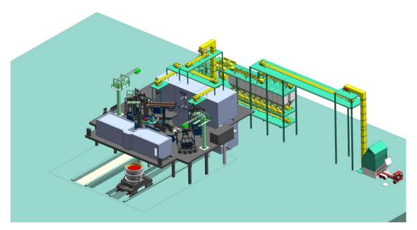
Primetals Technologies がロシア PAO Severstal 社のチェレポヴェツ製鉄所に納入するツインレードル炉の CG
