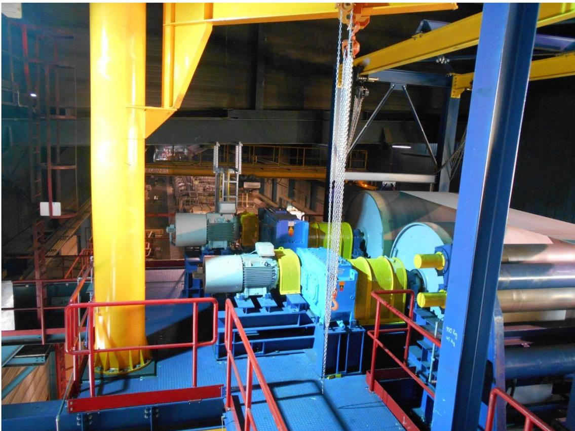
Area modernizada dos rolos tensores da linha de decapagem e recozimento da Aperam em Genk na Bélgica, que foi fornecida pela Primetals Technologies
