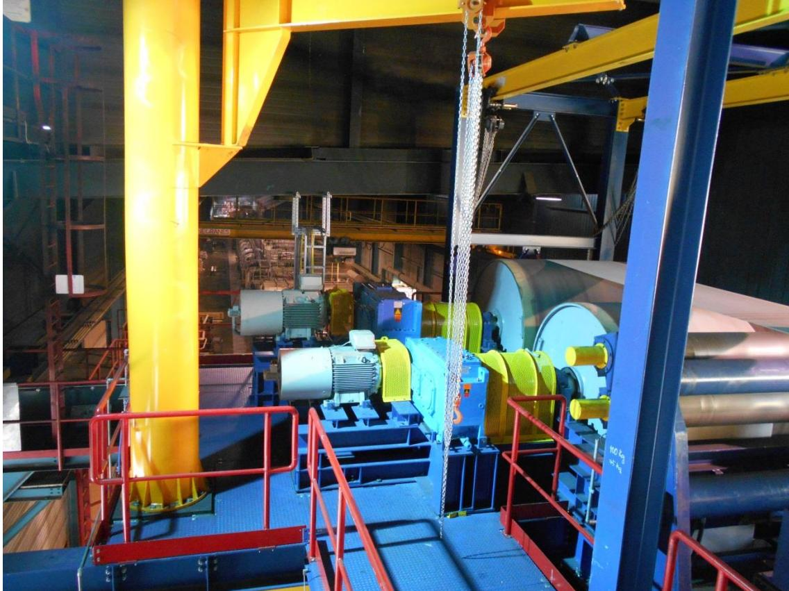
Модернизированное натяжное устройство линии отжига и травления на заводе компании Aperam в г.Генк, Бельгия. Модернизация выполнена компанией Primetals Technologies
