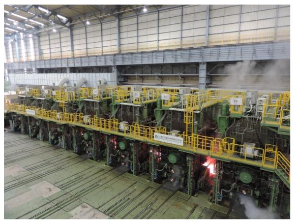
普锐特冶金技术为越南台塑河静钢铁公司所提供热轧机的精轧机。7个精轧机架中有4个采用了对辊交叉技术,以优化板形控制 (Photo courtesy of FHS)。
