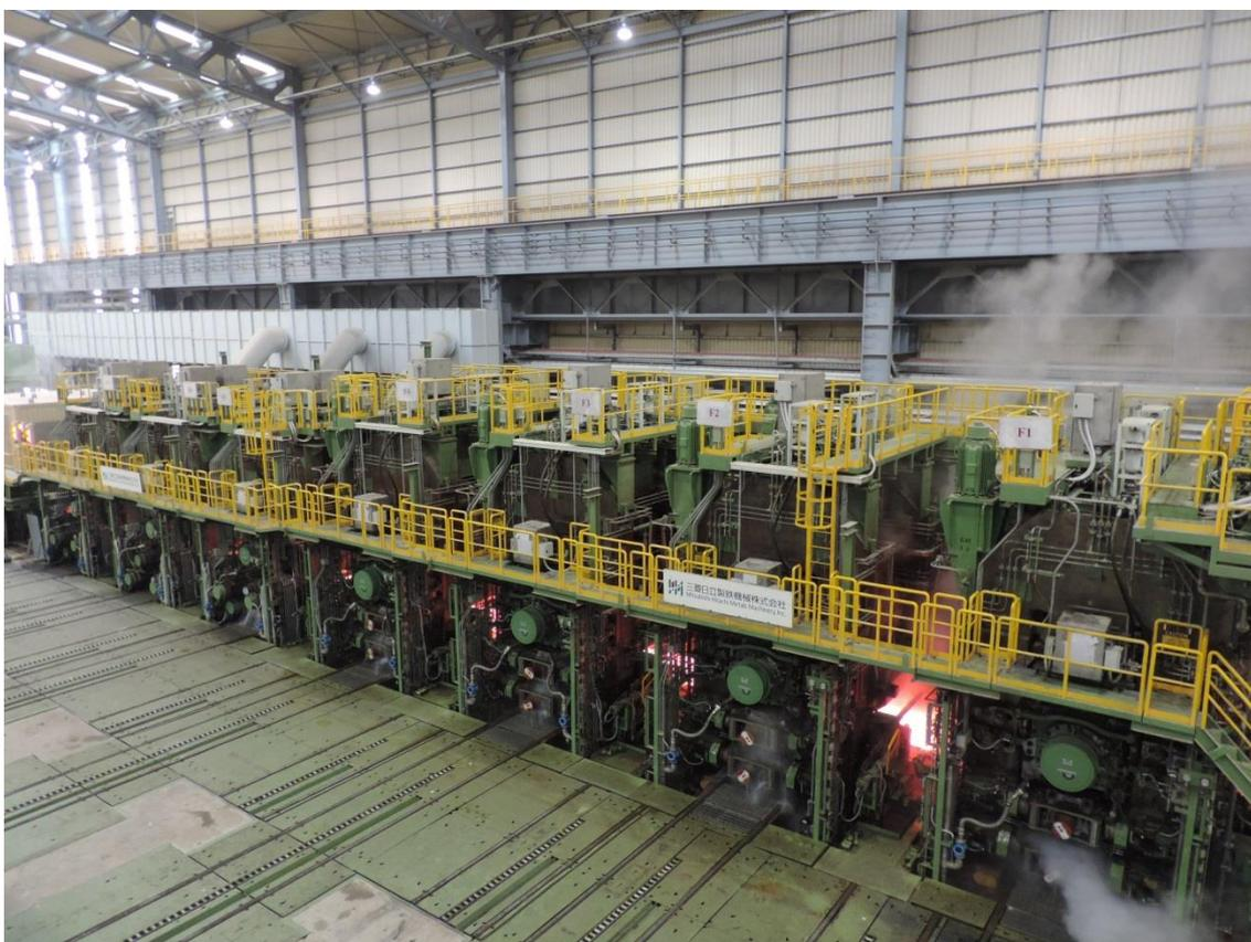
Fertigstraße des Warmwalzwerks von Primetals Technologies bei der Formosa Ha Tinh Steel Co. in Vietnam. Zur optimalen Profilsteuerung sind vier der sieben die Gerüste mit Pair-Cross-Technologie ausgestattet. (Foto mit freundlicher Genehmigung von FHS).
