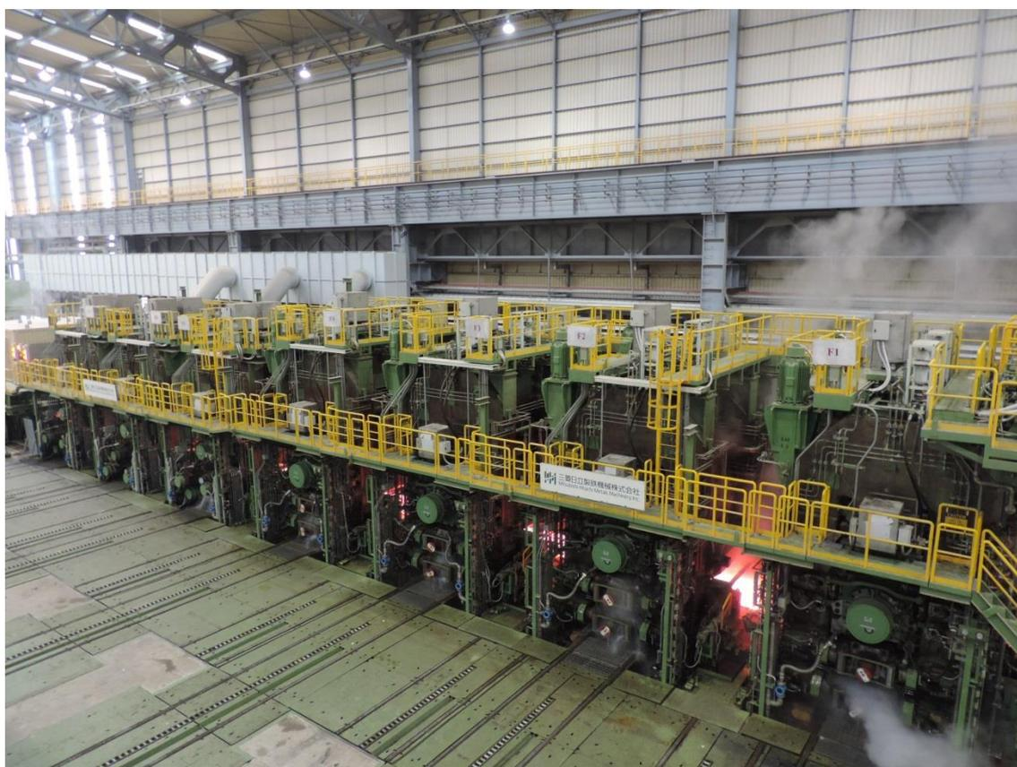
当社がベトナム・フォルモサハティン製鉄に納入した熱間圧延設備の仕上げ圧延機。ペアクロス技術を装備しプロファイル制御を最適化（写真提供：FHS）
