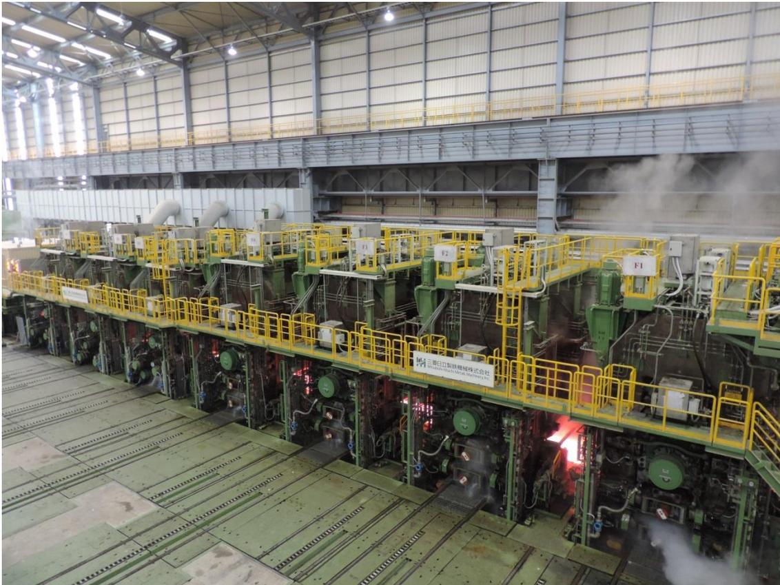
Trem acabador do laminador de tiras a quente da Primetals Technologies fornecido para a Formosa Ha Tinh Steel Co. no Vietnam. Quatro das sete cadeiras do trem acabador são equipadas com tecnologia de par cruzado para otimizar o controle progressivo de perfil. (Foto cortesia da FHS).
