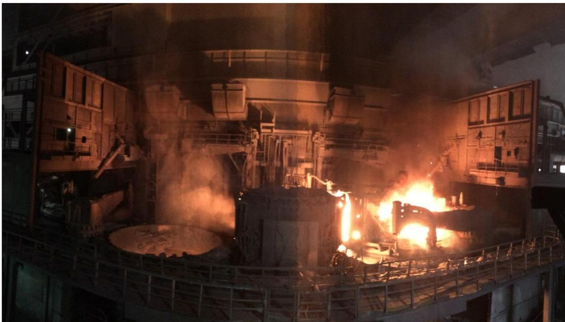
150-Tonnen-Doppel-Elektrolichtbogenofen bei Baosteel in Shanghai, China. Der Ofen wird von Primetals Technologies bis Ende 2016 modernisiert.
