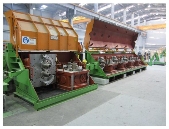
Primetals Technologies が Southwire Company, LLC を介して納入した1基目の銅棒材圧延製造ライン
