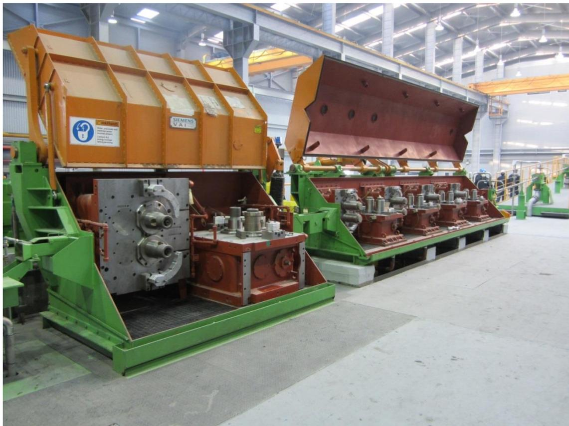
Linha de processamento de vergalhão laminado de cobre fornecido pela Primetals Technologies via Southwire Company, LLC.
