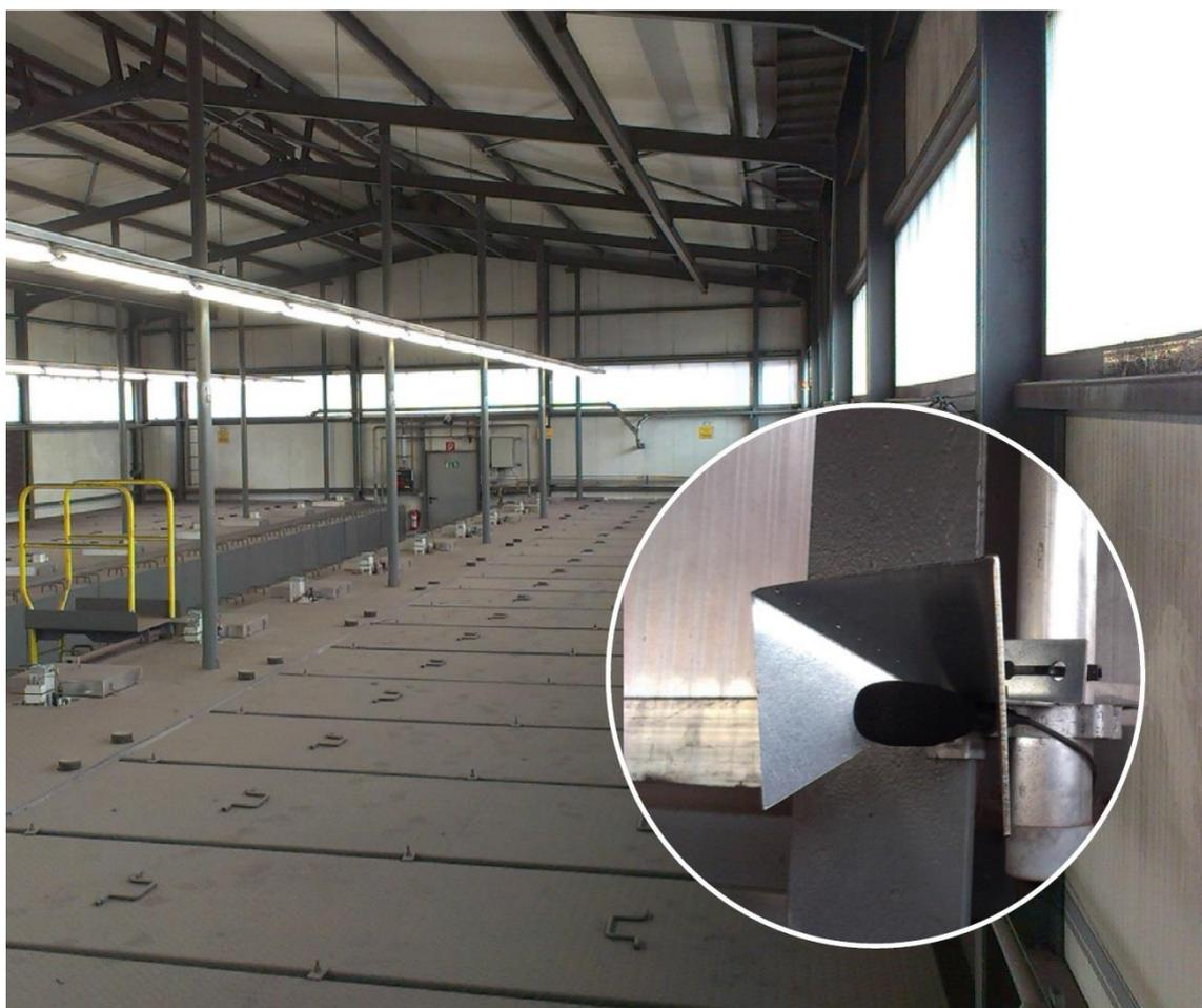
Schlauchfiltereinhausung und Industriemikrofon. Acoustic Expert misst und analysiert das Schallspektrum und ermöglicht so eine zustandsbasierte Instandhaltungsstrategie.
