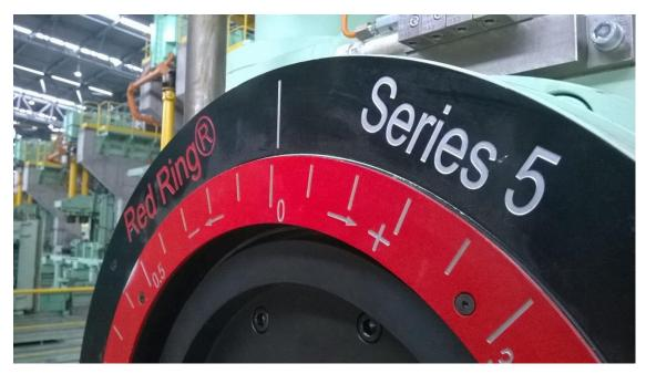
Hennigsdorfer Elektrostahlwerke GmbH(H.E.S)棒材轧机的粗轧机组上安装了两个普 锐特冶金技术提供的 Series 5 红圈机架。
