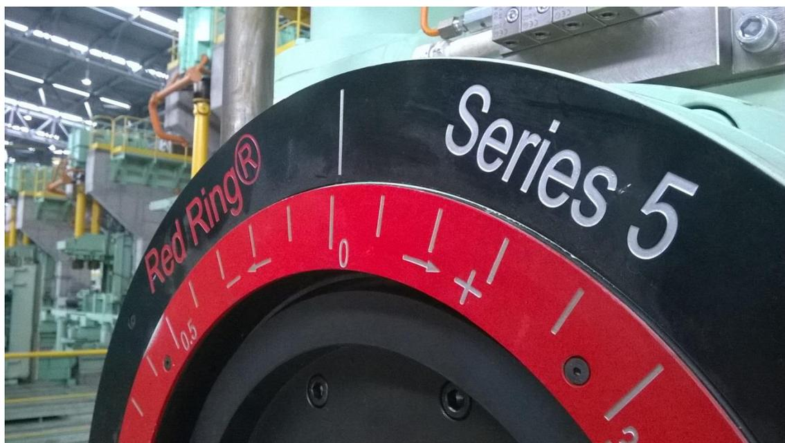
Gabbia di laminazione Red Ring series 5 di Primetals Technologies. Due di queste gabbie sono state installate nel treno sbozzo del laminatoio barre di Hennigsdorfer Elektrostahlwerke GmbH (H.E.S).
