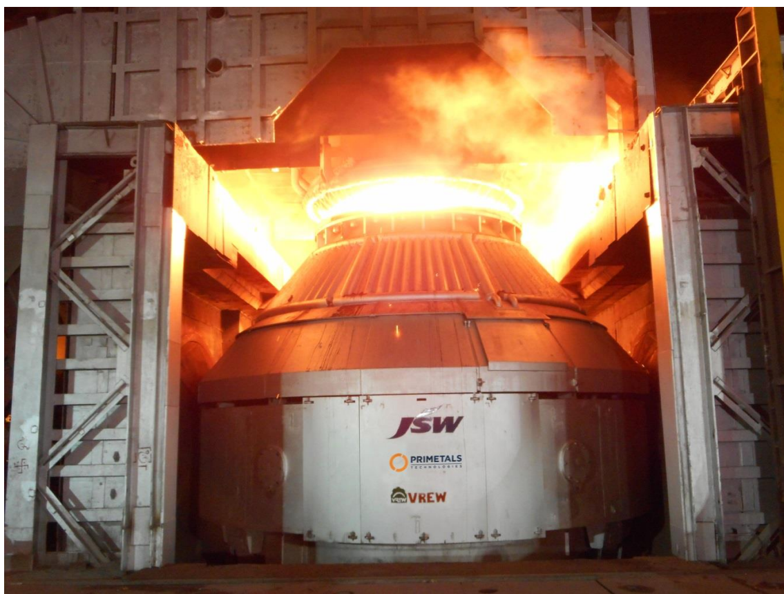
Conversor LD (BOF) da Primetals Technologies na Aciaria nr.2 da JSW Steel em Vijayanagar, Toranagallu, Índia.
