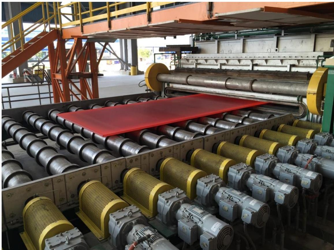
Выходная секция линии нормализации, поставленной мексиканскому производителю стали Altos Hornos de México S.A.B de C.V. (AHMSA) компанией Primetals Technologies. Здесь в мае был обработан первый лист.
