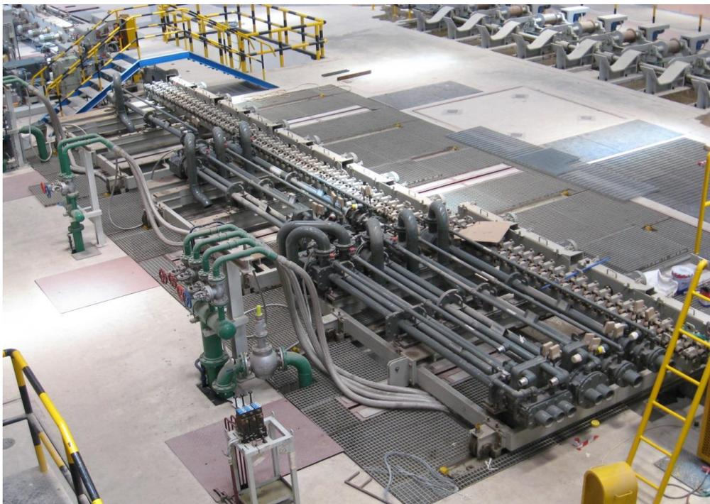
Il sistema di raffreddamento in linea PQS di Primetals Technologies dà alle barre un anello esterno martensitico rivenuto e un cuore ferritico-perlitico.
