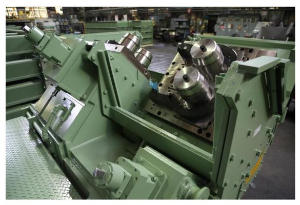
普锐特冶金技术为高速线材轧机制造的 250 mm 高能力超重型(UHD)机架。
