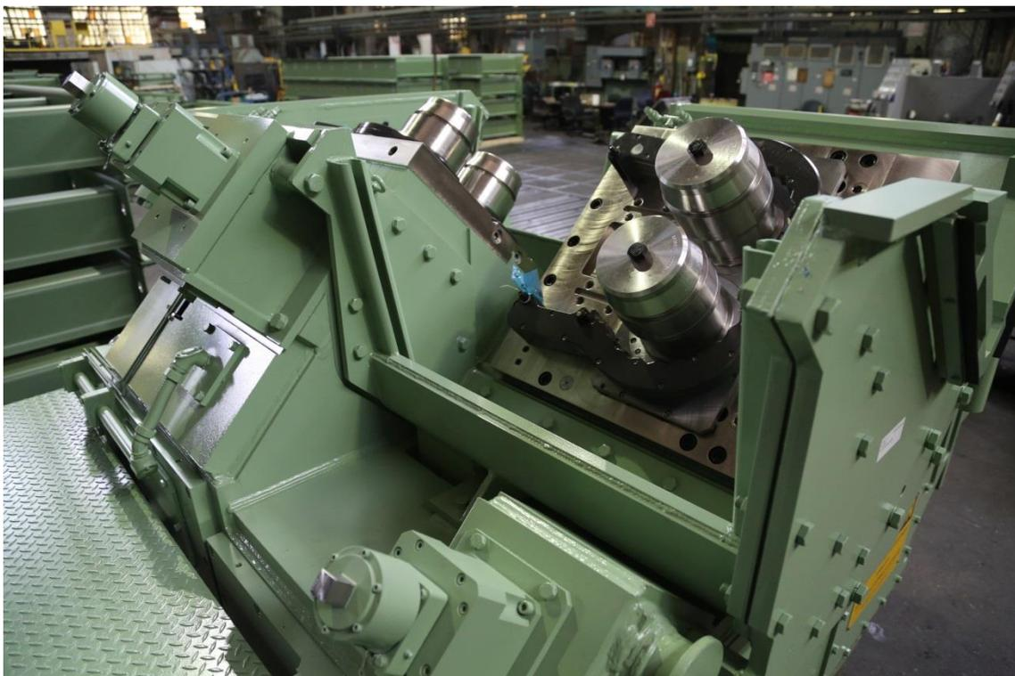
Самый мощный в мире блок (250 мм, для сверхтяжёлых режимов работы) для установки на мелкосортном прокатном стане производства Primetals Technologies. Фото перед отгрузкой.
