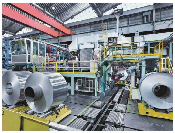
奥地利阿马格(AMAG)轧材有限责任公司兰绍芬(Ranshofen)厂的铝带生产。普锐特治金技术将对其 4 辊冷轧机架进行传动技术改造(照片由 AMAG 轧材有限责任公司提供)。
