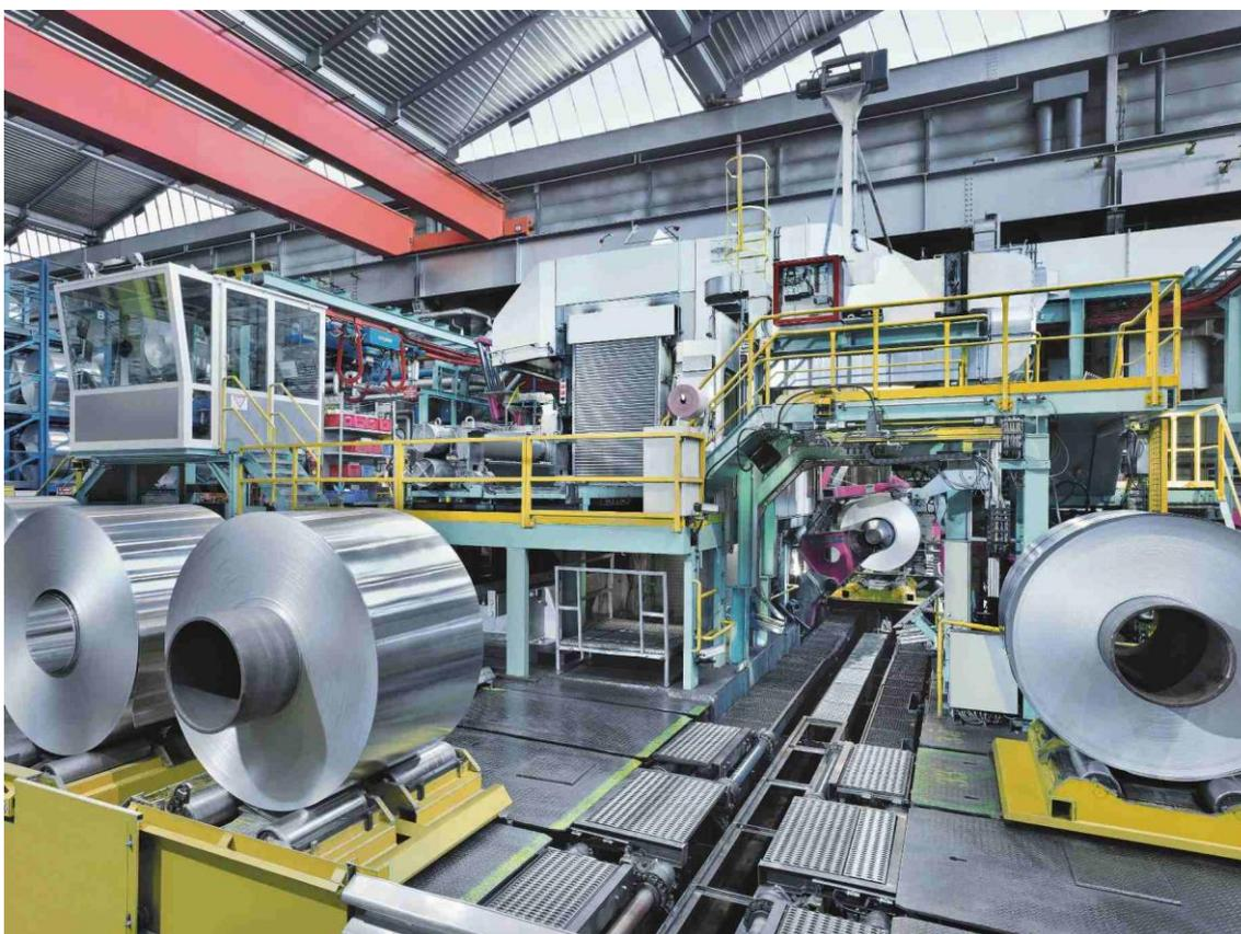
Производство алюминиевой полосы на заводе компании AMAG rolling GmbH в г.Рансхофен, Австрия. Primetals Technologies проводит модернизацию системы приводов четырёхвалковой клетки стана холодной прокатки (фото: AMAG rolling GmbH)
