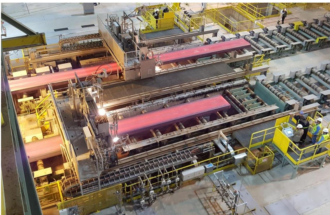
Zweisträngige Brammenstranggießanlage von Primetals Technologies bei dem brasilianischen Stahlerzeuger Companhia Siderúrgica do Pecem (CSP). Die Anlage ist Teil eines neuen Werks im Pecem Industrial and Port Complex in São Gonçalo do Amarante im Bundesstaat Ceará.
