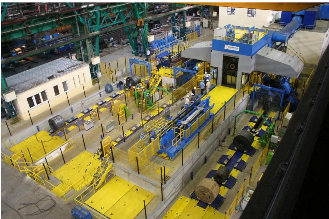
Laminador a frio reversível (RCM) da Primetals Technologies. Um laminador similar será instalado na planta de Ixtaczoquitlan da siderúrgica mexicana Talleres y Aceros S.A. de C.V. (Tyasa)
