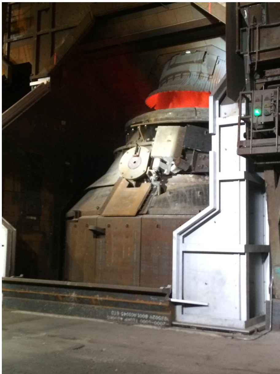
Conversor LD (BOF) fornecido pela Primetals Technologies para a usina finlandesa de Raahé da SSAB Europe Oy
