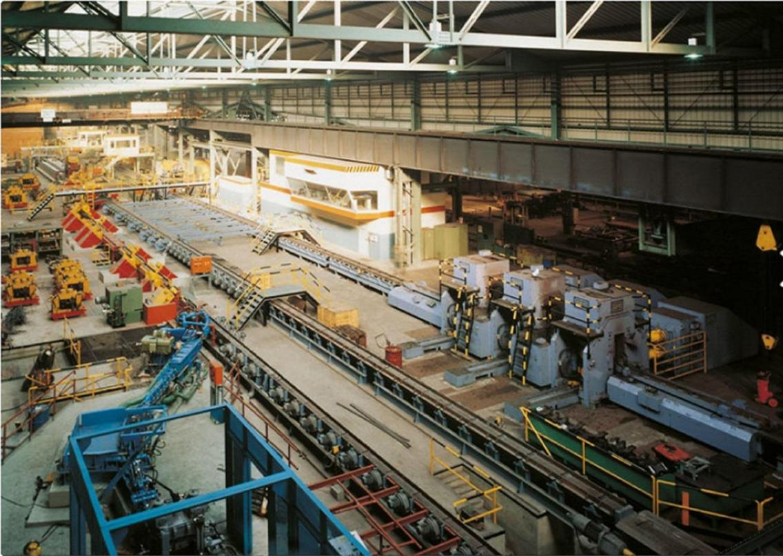
Primetals Technologies が新駆動・オートメーションシステムを供給するボーラー・エデルシュタール社の平鋼圧延機（オーストリア・カップフェンベルク。写真提供: Böhler Edelstahl GmbH & Co KG)
