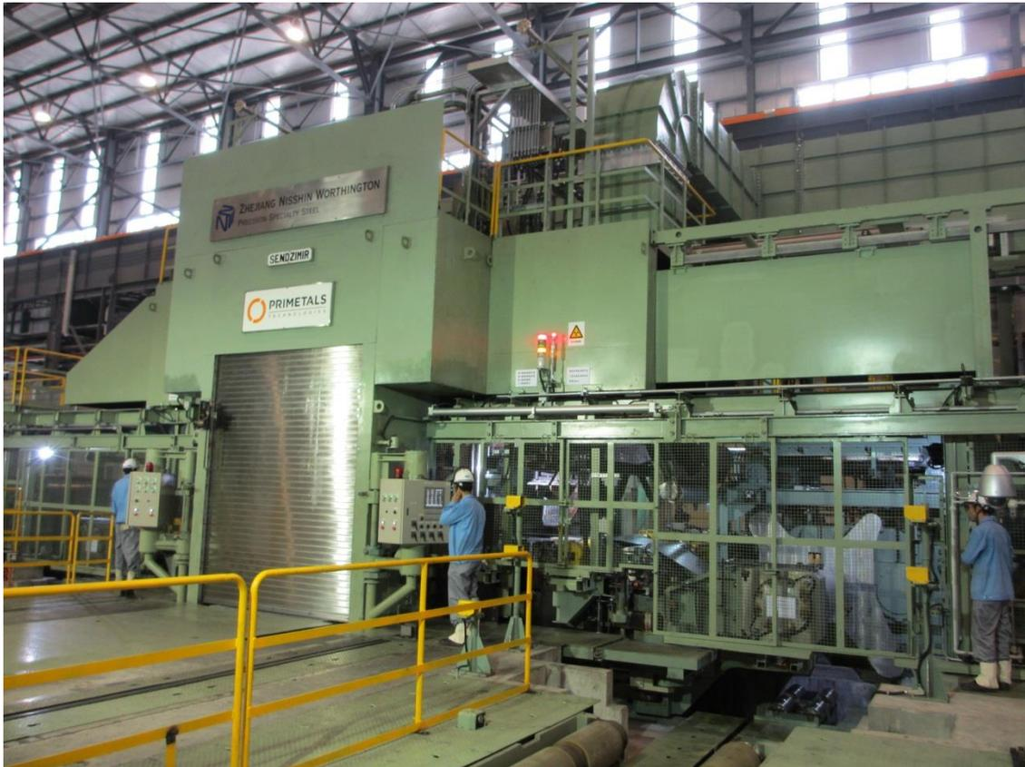
Frontansicht der „Z-Hi“-Reversierkaltwalzstraße von Primetals Technologies bei Zhejiang Nisshin Worthington Precision Specialty Steel Co., Ltd. in Pinghu, Provinz Zhejiang, China. Die Anlage kann ein Quarto-Gerüst für Spezialstahl ersetzen.
