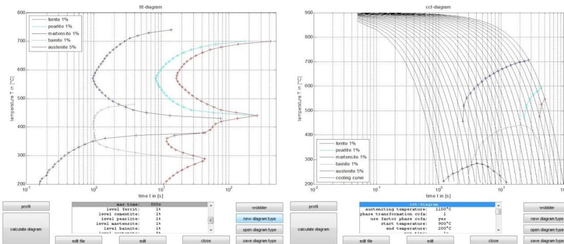
普锐特冶金技术将为 SSAB 欧洲钢铁公司芬兰拉赫钢厂的热带钢轧机改造冷却段自动化系统。上图展示了一种特殊钢种的 TTT（等温转变）图和相应的 CCT（连续冷却转变）图。
