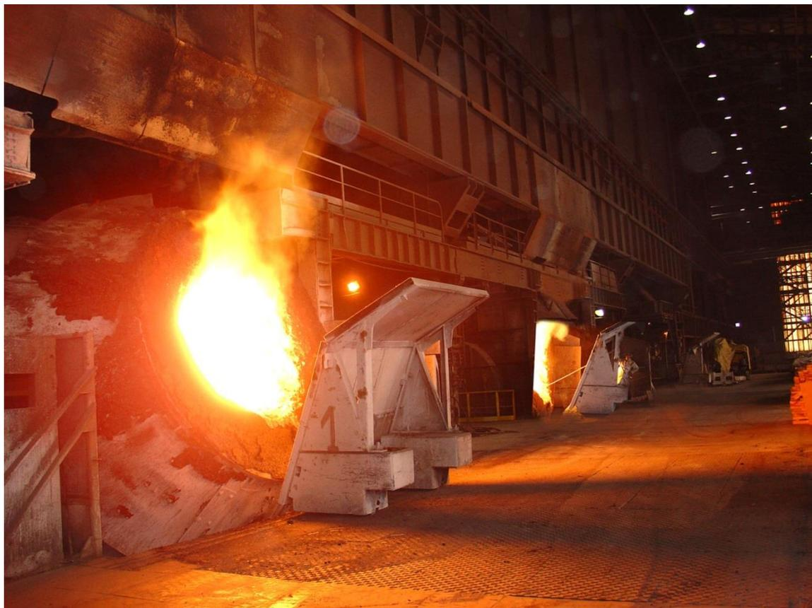
チリ・ビオビオ州のCAP ACERO社タルカワノ製鉄所のLD（BOF）転炉。Primetals Technologiesが第2転炉を新型炉に更新予定。（写真提供：CAP ACERO）
