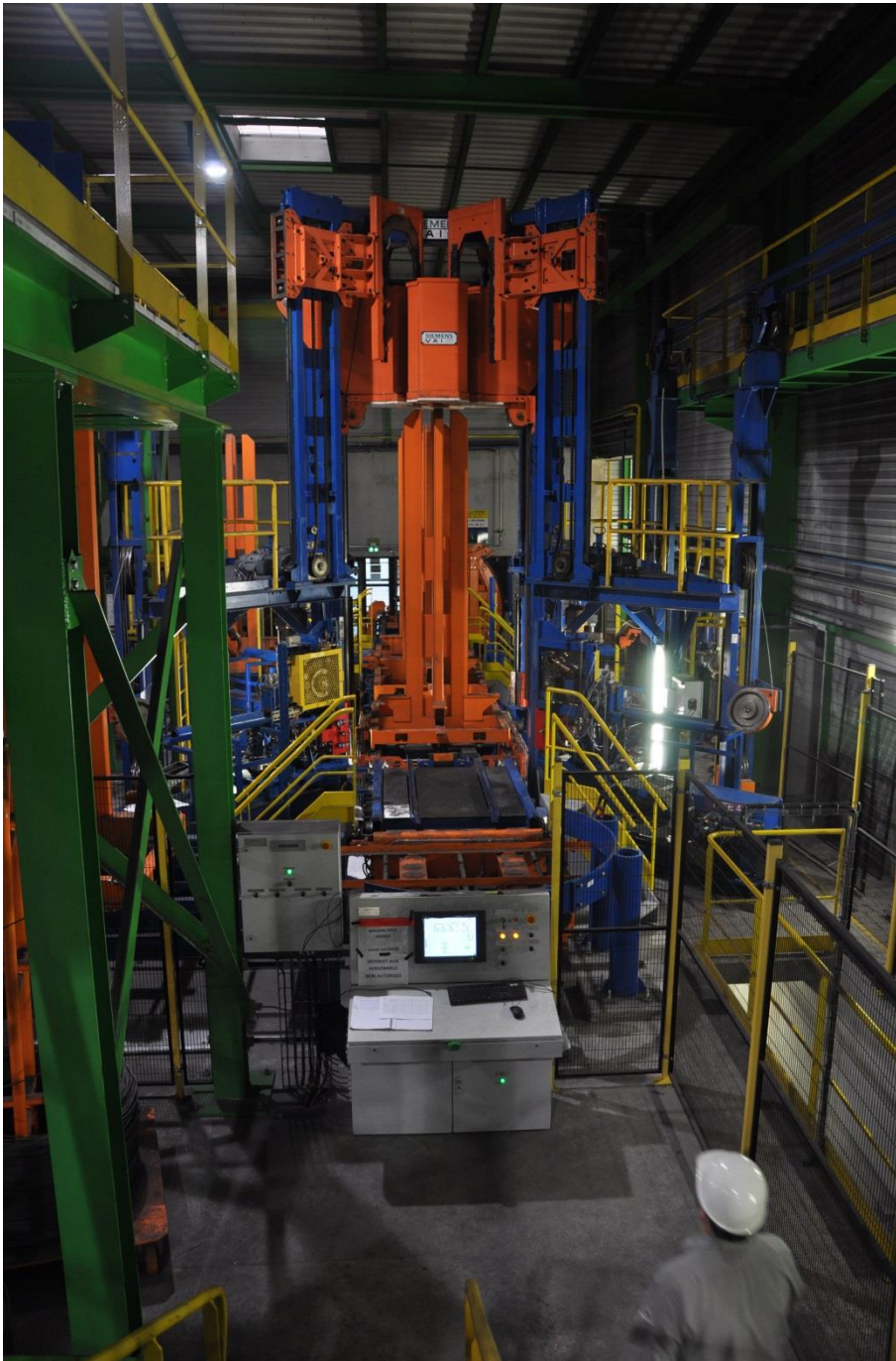
Primetals Technologies 製の垂直方式コイル圧縮システム
