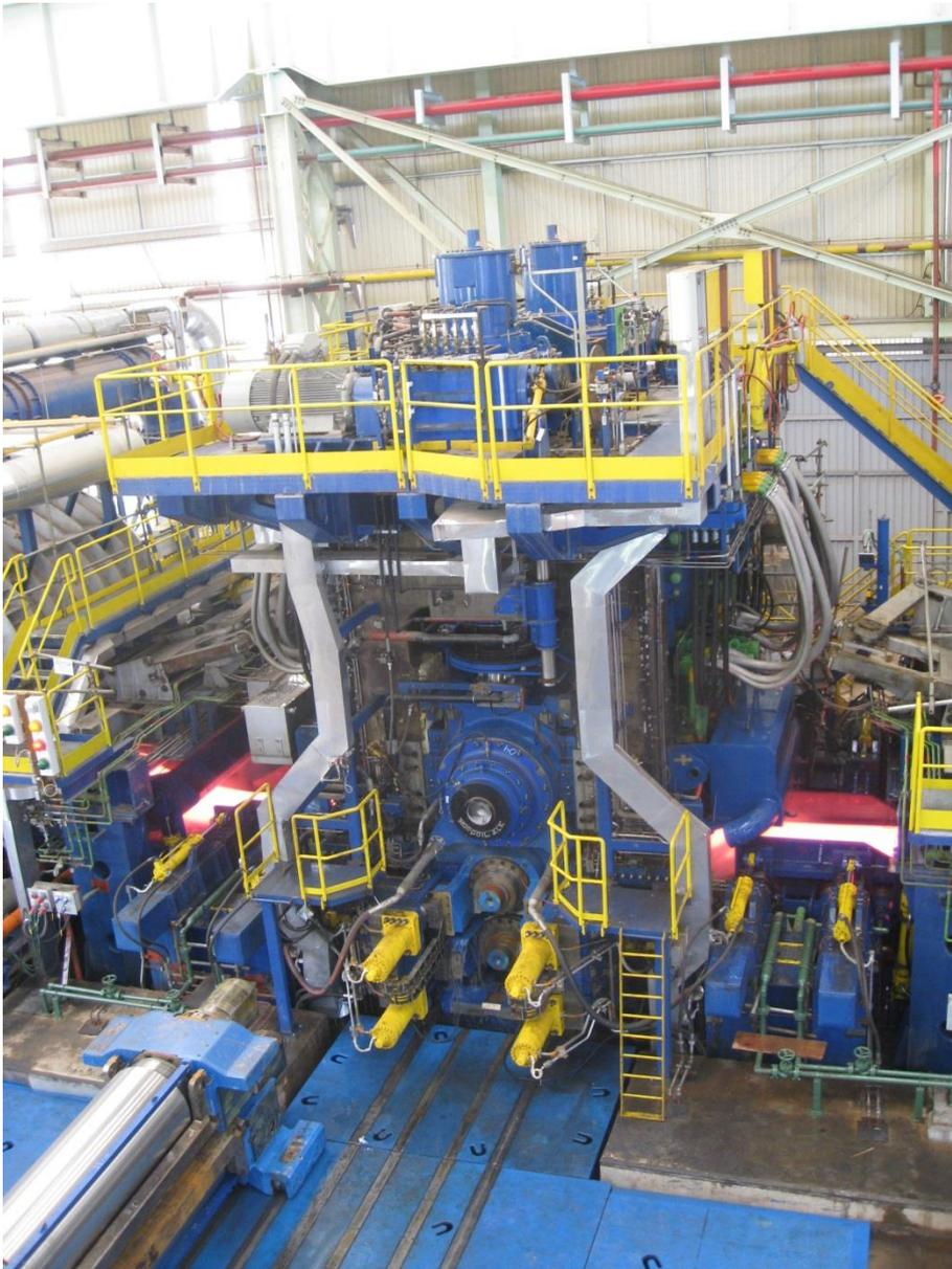
Steckelwalzwerk von Primetals Technologies am Produktionsstandort
