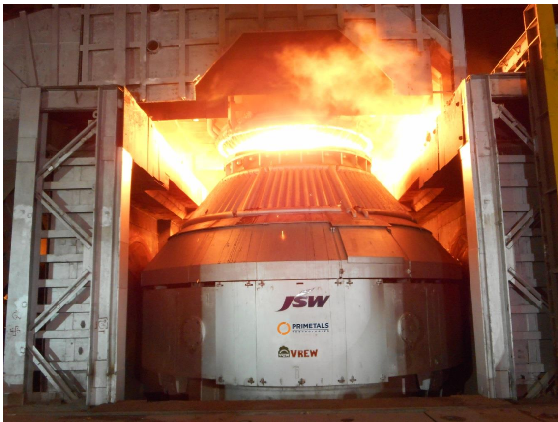
LD(BOF)-Konverter von Primetals Technologies im Konverterstahlwerk Nr. 2 von JSW Steel in Vijayanagar, Toranagallu, Indien.
