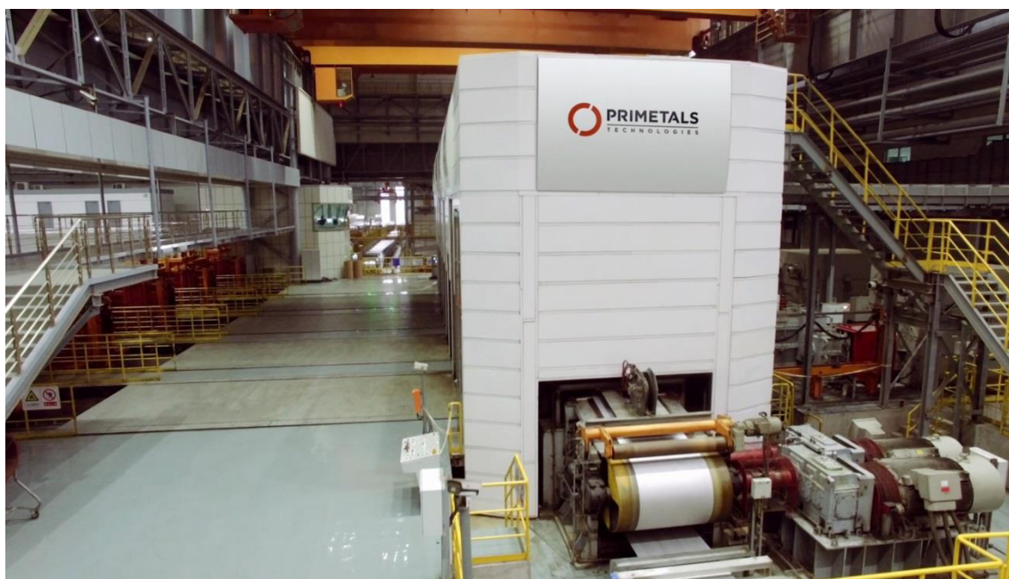
Стан холодной прокатки, поставленный Primetals Technologies для Tangshan Iron and Steel Group Co. Ltd.
