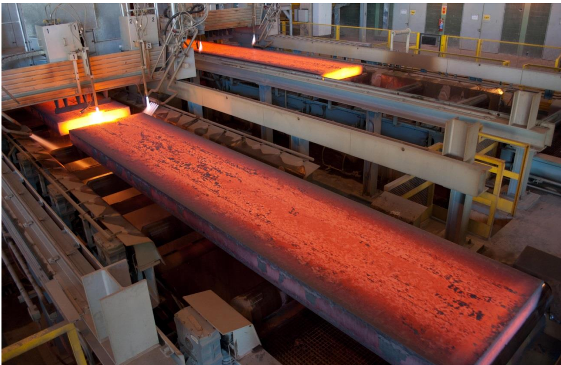
Placas produzidas em uma máquina de lingotamento contínuo da Primetals Technologies
