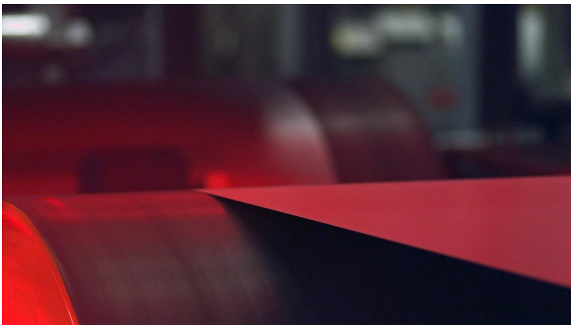
Inspektion eines verzinkten Bands mit einem SIAS-System von Primetals Technologies
