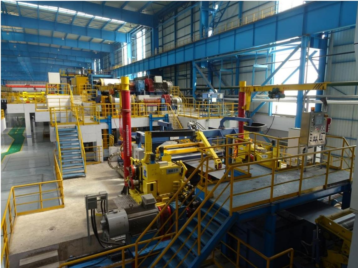
普锐特冶金技术为日照钢铁控股集团有限公司提供的连续酸洗线圆盘剪段
