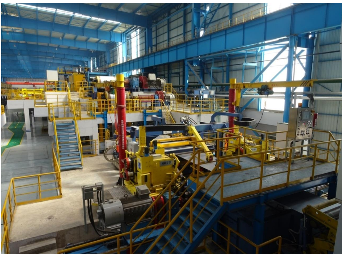
Кромкообрезная секция агрегата непрерывного травления производства Primetals Technologies at Rizhao Steel Group Co., Ltd в г. Риджао провинции Шандунь, КНР
