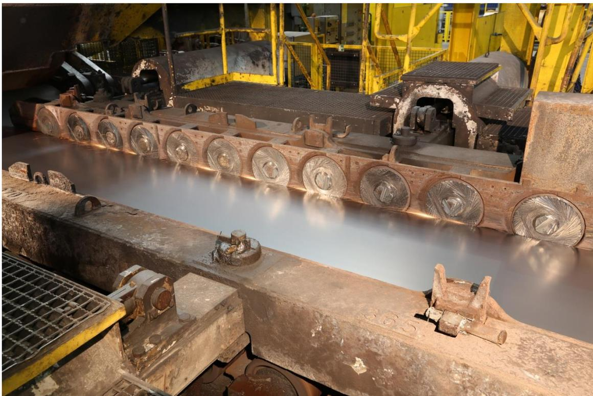
Guias laterais com vigas Eco Slide Disc, fornecidas pela Primetals Technologies, no lado de entrada da bobinadeira na laminação de tiras a quente da voestalpine Stahl em Linz, Áustria.
