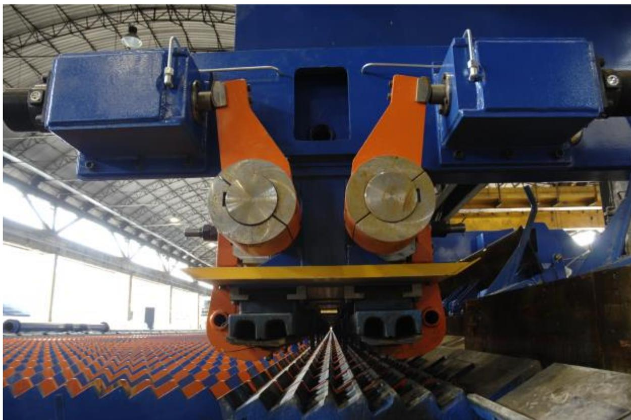
Sistema di frenatura ad alta velocità di Primetals Technologies per un laminatoio barre
