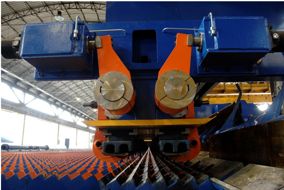
Высокоскоростная выходная секция пруткового стана от Primetals Technologies
