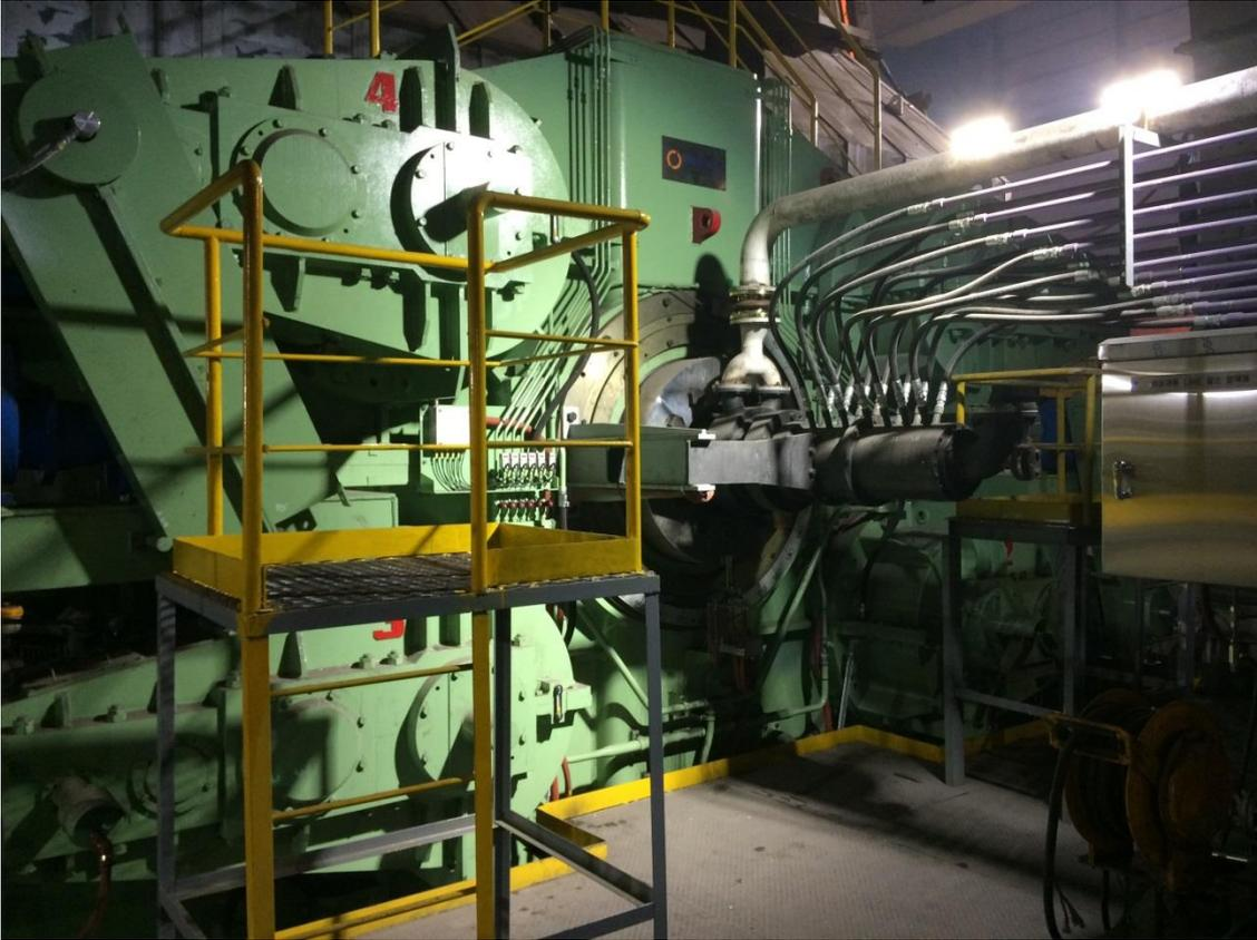
プライメタルズ テクノロジーズが韓国の Posco 光陽製鉄所第 1 工場の第 1 転炉に納入した傾動装置。
