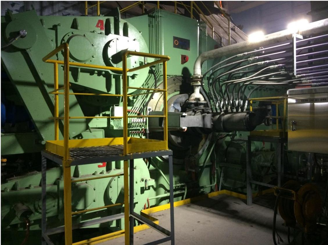
Acionamento do basculamento da Primetals Technologies no convertedor nº 1 da Aciaria nº 1 da usina da Posco em Gwangyang, Coréia do Sul.
