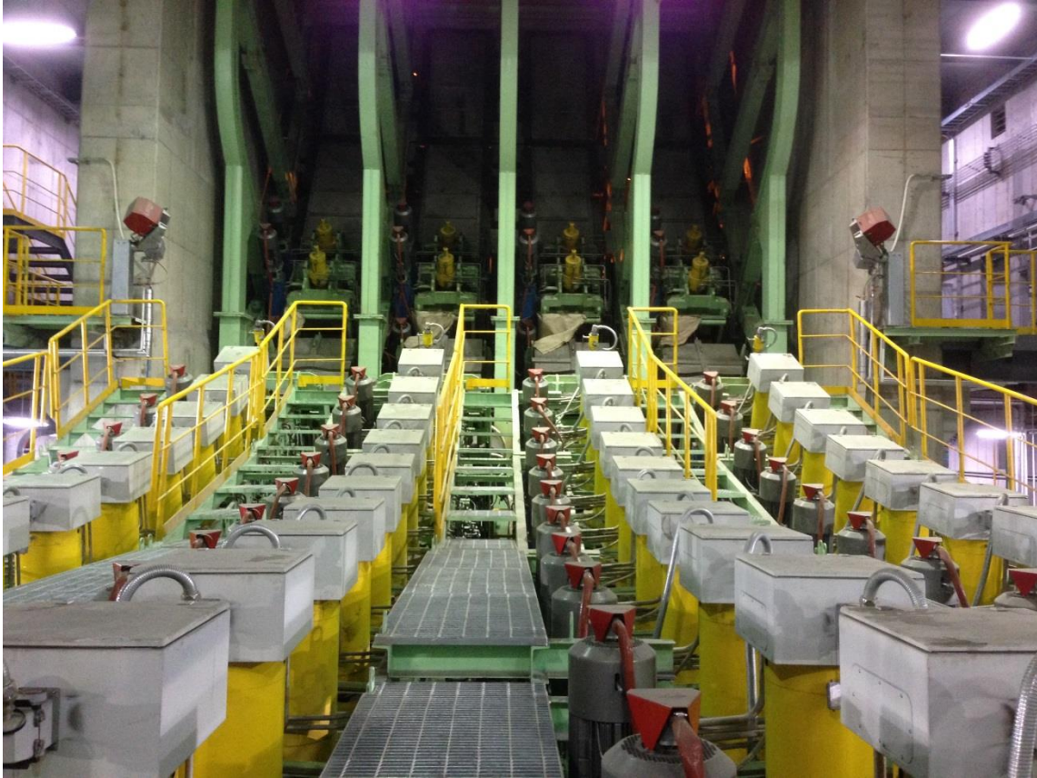
普锐特冶金技术为韩国现代钢铁公司唐津厂提供的大方坯连铸机
