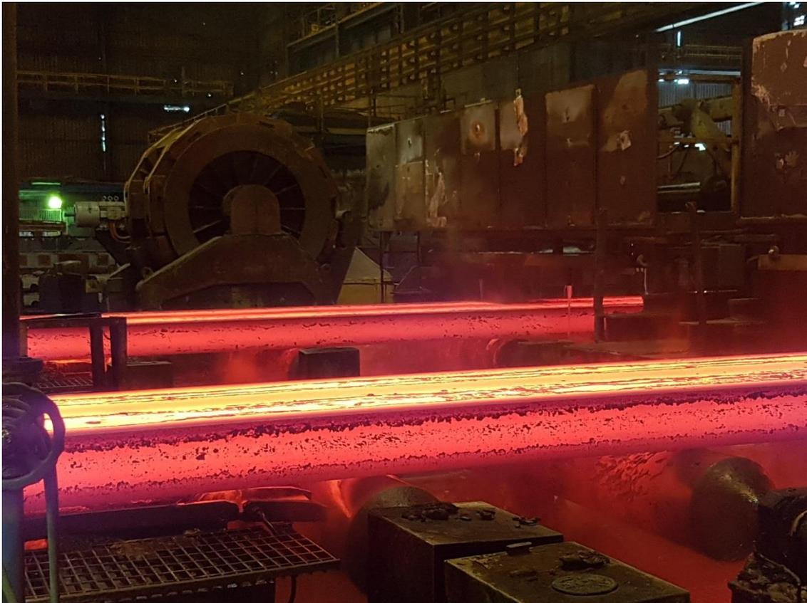
Seção de saída de uma máquina de lingotamento contínuo na usina da Companhia Siderúrgica Nacional (CSN) em Volta Redonda, Brasil. A Primetals Technologies está modernizando três das máquinas de lingotamento contínuo da CSN (foto por cortesia da CSN).
