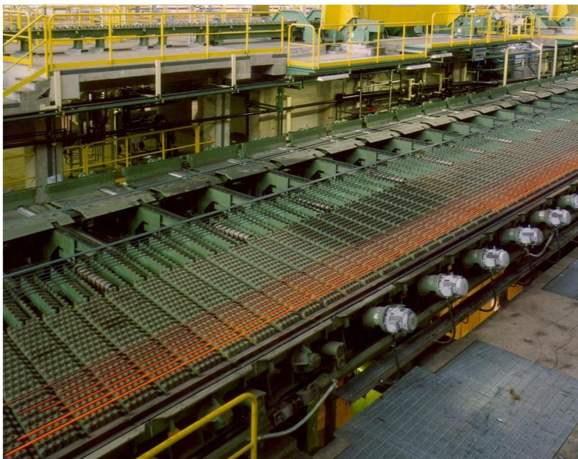
冷却床上の棒鋼。プライメタルズ テクノロジーズは、SBQ 直棒鋼市場への展開を目指す米国のチャータースチール・クリーブランド工場の設備近代化を受注。
