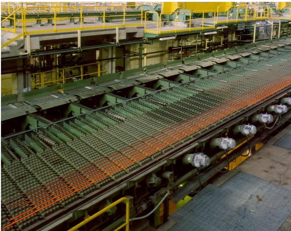
Barras em um leito de resfriamento. A Primetals Technologies fornecerá equipamentos para a modernização da planta da Charter Steel em Cleveland visando entrar no mercado de barras retas especiais.
