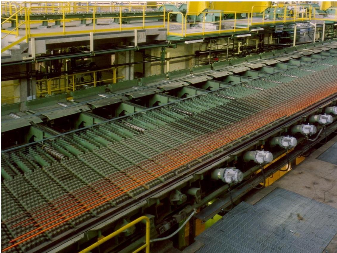
Прямой пруток на холодильнике. Primetals Technologies поставит на завод Charter Steel в Кливленде оборудование для модернизации, проводимой с целью выхода на рынок прямых прутков специального качества.
