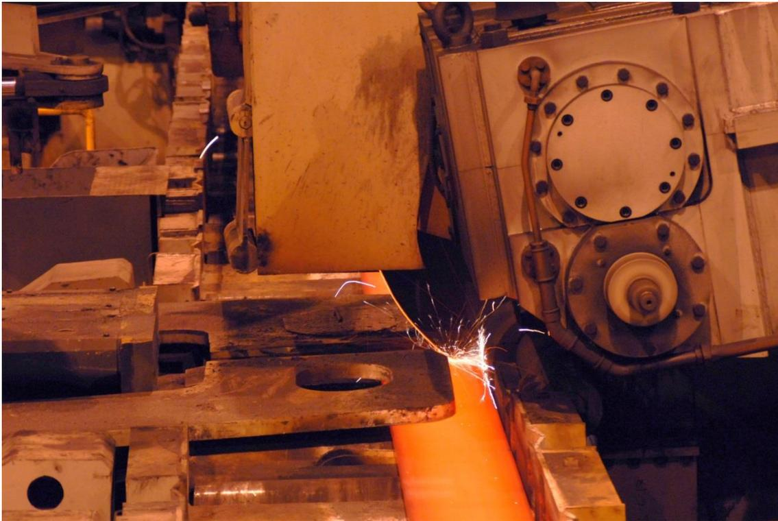
Sega a disco abrasivo per piatti di qualità di Primetals Technologies. Un sistema simile verrà installato nel laminatoio di Çemtaş a Bursa, Turchia.
