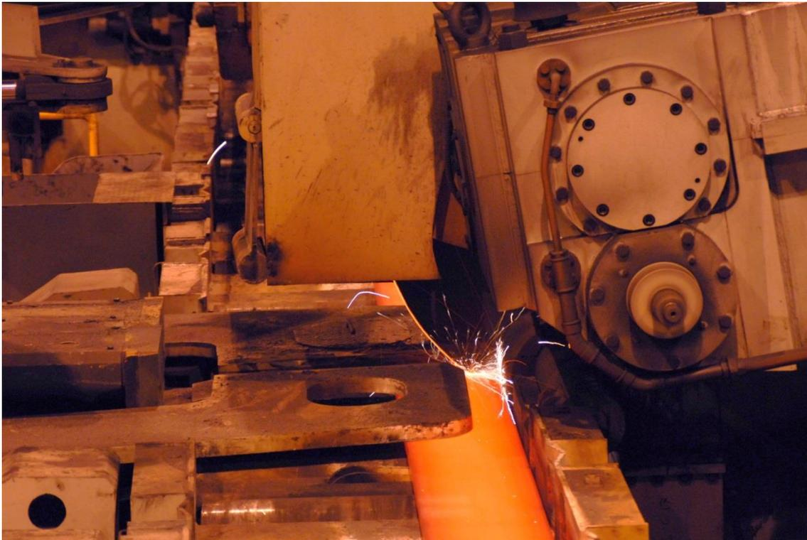
Unidade de serra abrasiva da Primetals Technologies para barras chatas de alta qualidade. Um sistema similar será instalado no laminador de barras da Çemtaş, em Bursa, Turquia.
