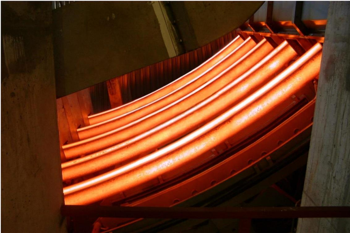
普锐特冶金技术将为奥钢联钢铁公司奥地利 Leoben 钢厂提供 4 流大断面连铸机(4 号铸机)。照片中是同一钢厂的 3 号大方坯铸机，也是由普锐特冶金技术提供的。
