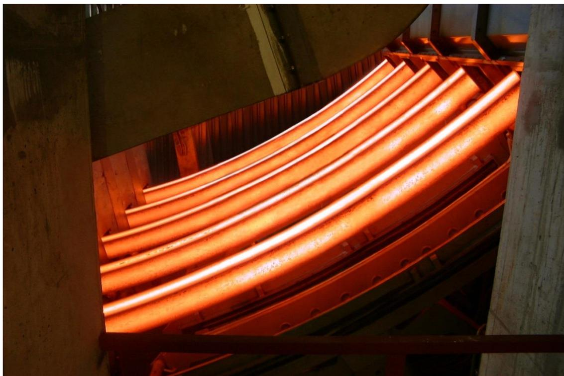
プライメタルズ テクノロジーズはオーストリア・レオーベンのフェストアルピーネ社製鉄所向けに 4 ストランド式のブルーム連続鑄造機 4 号機を受注。写真はプライメタルズ テクノロジーズが同製鉄所に納入した 3 号機。
